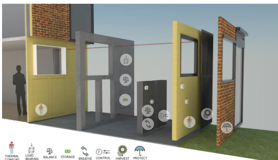
Paveikslas 4-11. „AdaptiWall“ sistemos sluoksniai ir jų funkcijos
