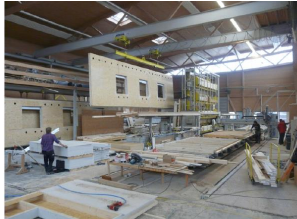
2.1. pav. Sienos skydo gamyba gamykloje (projekto "E2ReBuild" nuotrauka)
