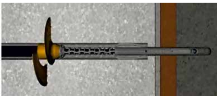
7.7 pav. Šiltinimo plokštės tvirtinimas sraigatine smeige
