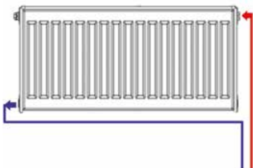
11.45 pav. Kryžminiu būdu prijungtas radiatorius
