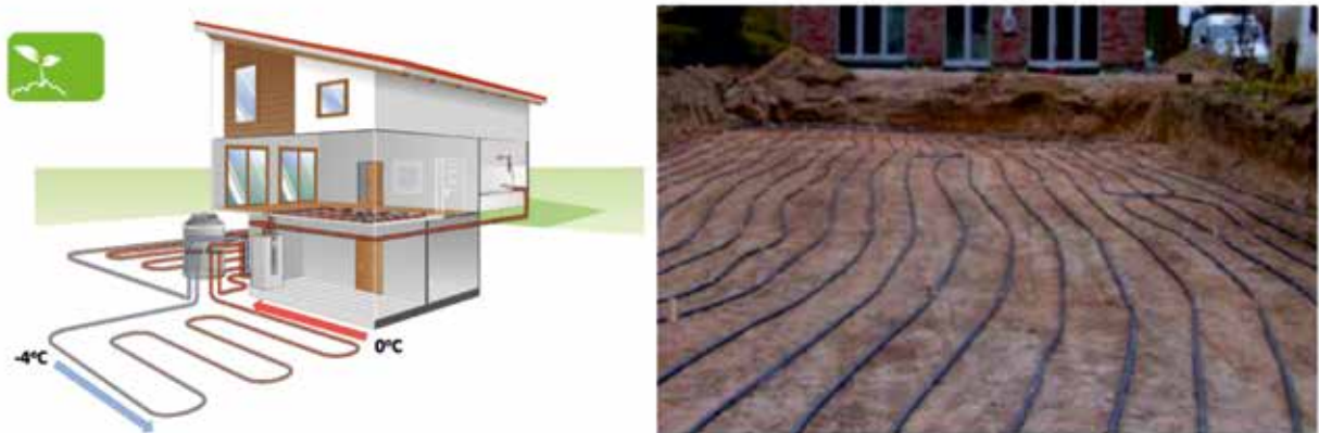
12.27 pav. Horizontalaus kolektoriaus geoterminis šildymas
